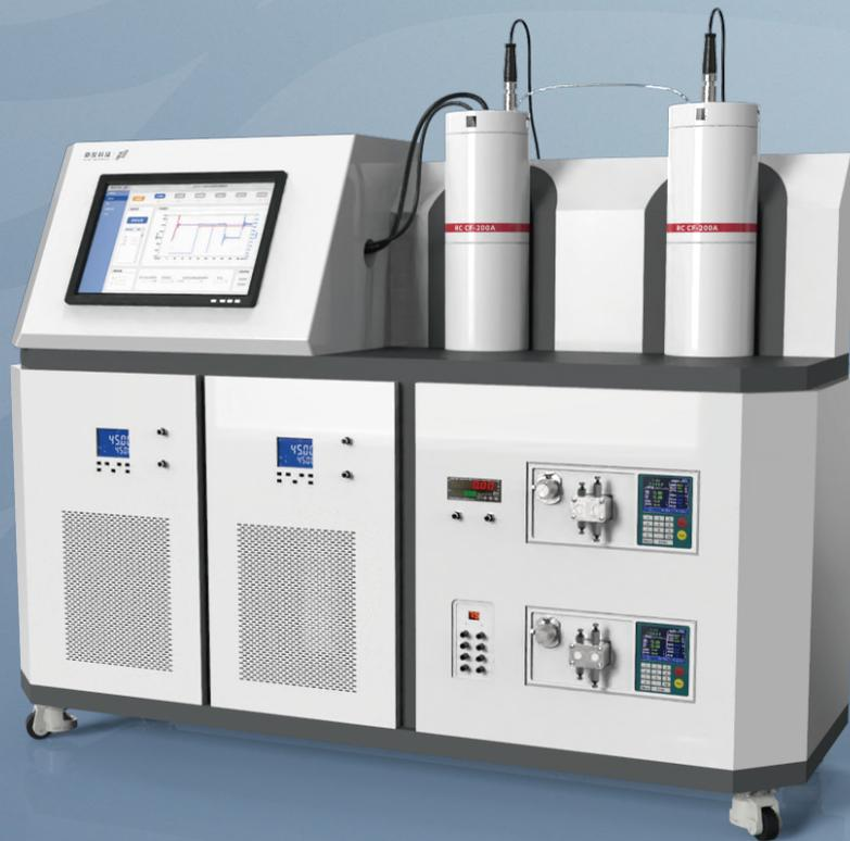
该产品是一款自动化程度高、可定制能力强的连续流动反应热分析与量热平台，平台具备自动进样、前置预热、自动脱气、流量控制、强化混合、精确控温、多点测温等功能，能够精确控制连续化反应条件，并实时监测各点温度变化。能够结合热分析理论，分析计算连续流反应器内的反应放热总量、热流分布、峰值温度、温度梯度等结果，可广泛应用于连续化反应的热力学和动力学参数分析、热风险评估和工艺优化等研究。
